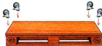
Die Kugelrollen auf den äußeren Pflocken in allen vier Ecken mit Schrauben befestigen.
