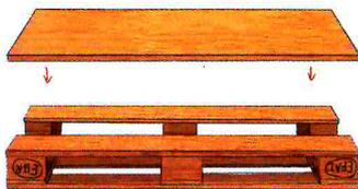
Die Palette mit der (offenen) Unterseite nach oben legen. Die Fichtenholzplatte passgenau auflegen und mit den Pflocken darunter fest verschrauben.
